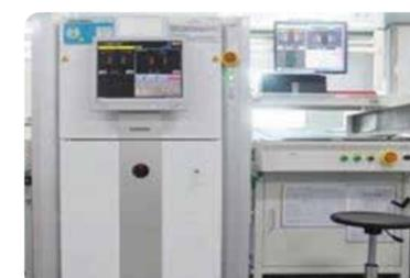
3D 在线式自动光学检测仪
